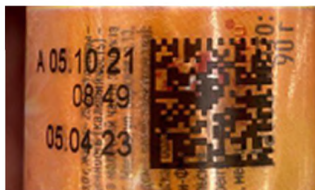
Печать кода маркировки на бликующей/светоотражающей поверхности
