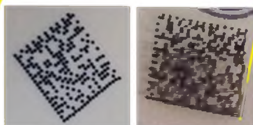
Нарушение геометрии кода маркировки (модуляция)
