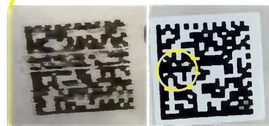
Смазывание кода маркировки или его отдельных элементов
