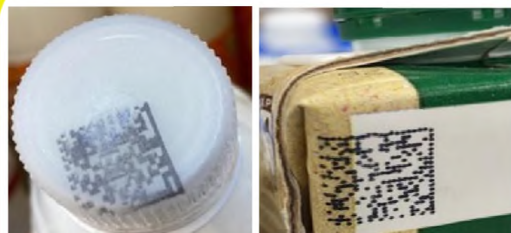
Смещение кода маркировки при печати
